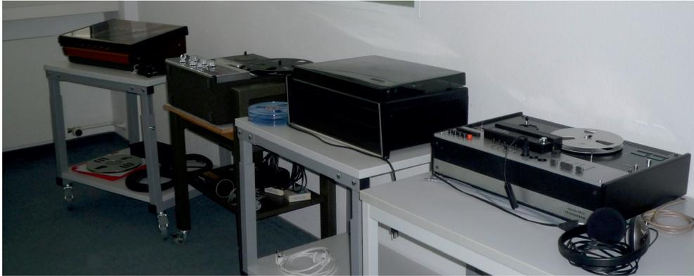
*Abb. 1: Unterschiedliche Tonbandgeräte zum Abspielen verschiedener Tonbänder mit unterschiedlichen Bandlaufgeschwindigkeiten und Spulengrößen.*
