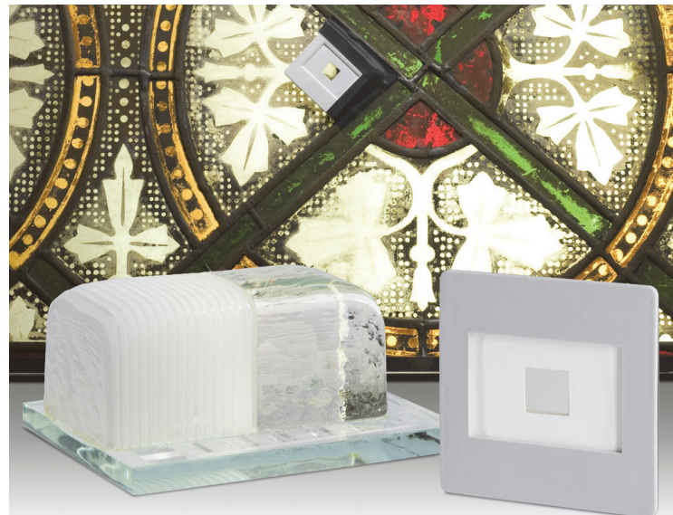
6 | Glasdosimeter vom Fraunhofer ISC. Links der Glasblock, aus dem die Dosimeter geschnitten werden. Rechts das fertige Dosimeter. Im Hintergrund sieht man ein Dosimeter an einem historischen Glasfenster.
