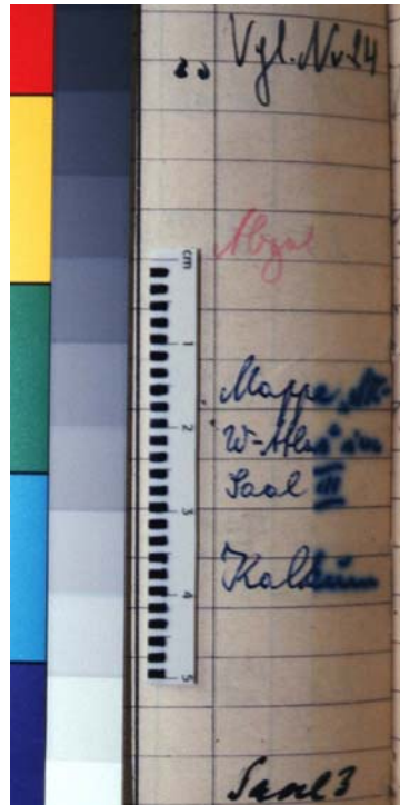
Abb. 4: Ausbluten von Farben unter „archivgeeignetem“ Selbstklebeband, aus: E.Galinsky: Kunststoff-Folien in der Papierrestaurierung - Schwerpunkt Deutschland, Leipzig 2001, 90, 207.
