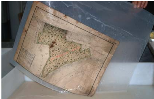
Abb. 9: Fixierung von Farben auf einer handgezeichneten Karte durch Eintauchen in die Neschen-Standardsuspension.
