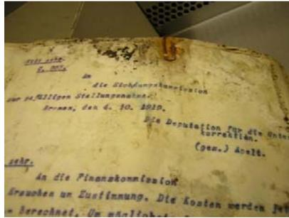
Stark wassergeschädigte Akte mit Aspergillus niger und Rost der Metallklammern
