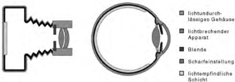
Abb. 9: Kamera und Auge entsprechen sich als optische Apparate weitgehend. In ihrer Funktion unterscheiden sie sich aber wesentlich.
