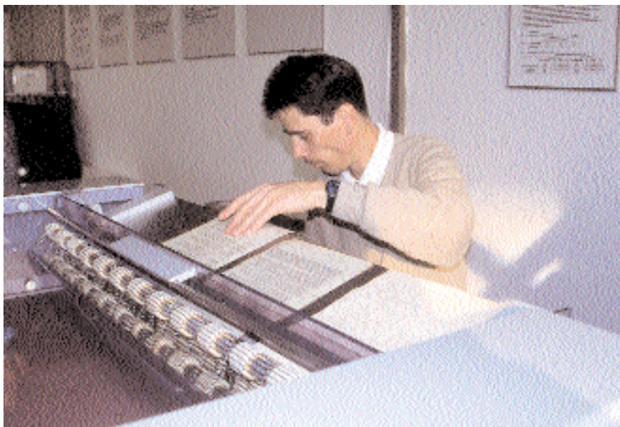
Die Unterlagen der Staatskanzlei Württemberg-Hohenzollern werden im Einzelblattverfahren von einem Mitarbeiter der Firma Neschen der Entsäuerungsanlage C 900 zugeführt.
